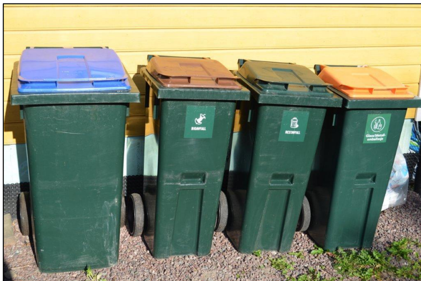
Figur 3-2: Standard beholderløsning for eneboliger (4 x 140 + perforert plastsekk)
