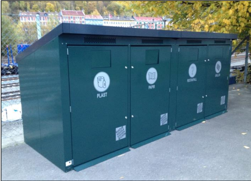
Figur 5-6: Eksempel på brannsikkert beholderskap
