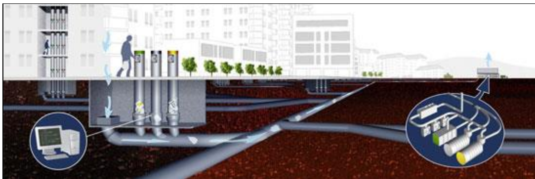
Figur 5-10 Stasjonært avfallssug. (Kilde: www.envac.no )
